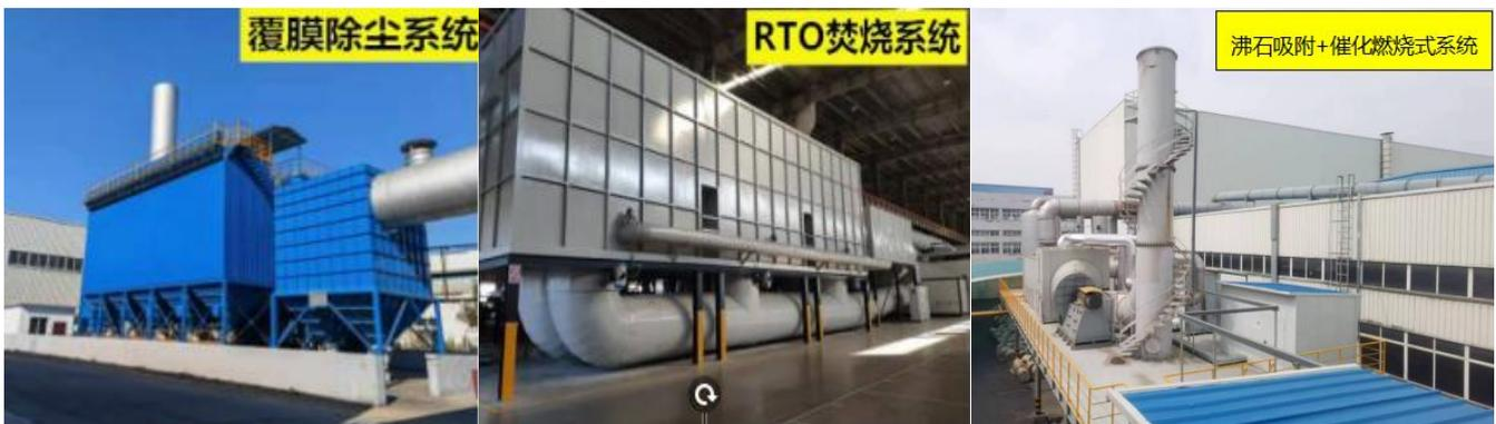
为确保各环保设备高效稳定运行，针对各环保设施制定运行管理规定。其中熔炼废气经集气罩收集后经覆膜布袋除尘器进行处理，处理后的废气经 25 米高排气筒达标排入大气，颗粒物可低于 10mg/m<sup>3</sup>；冷轧尾气经油雾风机收集后进入油雾回收净化系统多级处理净化后经 30
